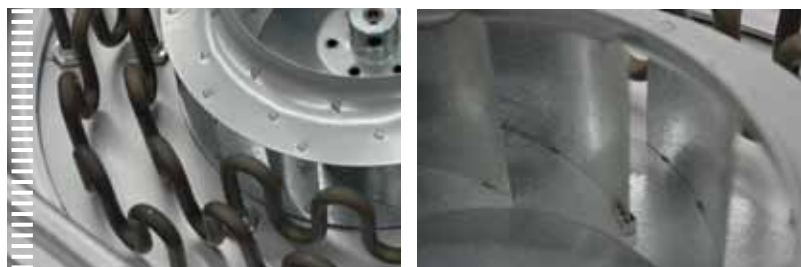
Турбинная система обдува заботится о равномерном распределении воздуха вокруг продукта
